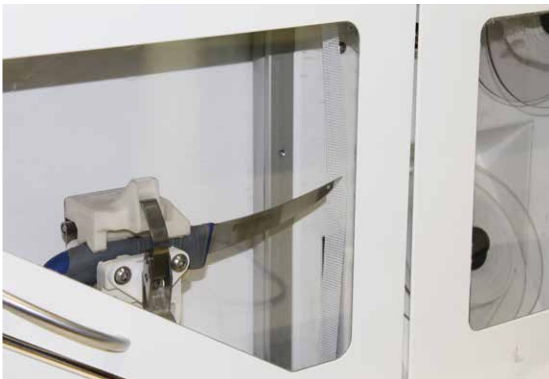
Тестирование остроты лезвия на станке Anago-Cozzini PrimEdge
